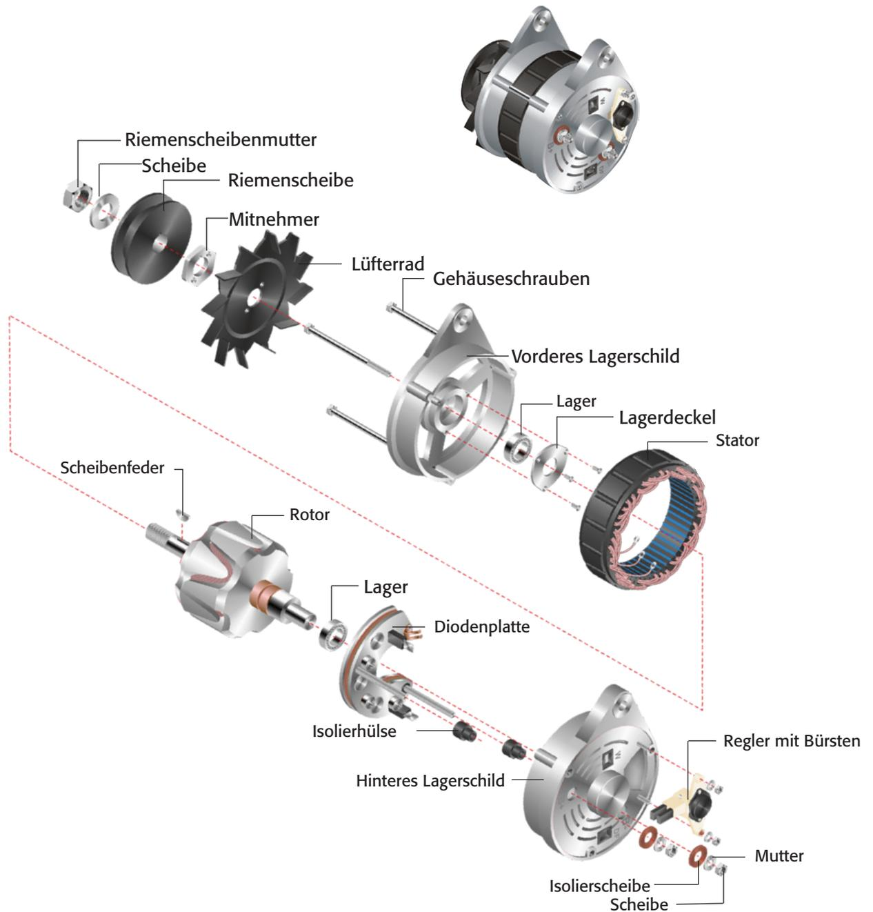
Drehstromlichtmaschinen sind, mechanisch betrachtet, ihren Gleichstromvettern nicht unähnlich. In beiden Stromerzeugern läuft ein Rotor (auch Läufer oder Anker genannt) in einem Gehäuse, in dem eine oder, bei der Drehstrommaschine, mehrere Wicklungen fest angebracht sind. Das Gehäuse ist an beiden Enden mit Deckeln, auch Lagerschilde genannt, versehen, in dem sich die Lagersitze des Rotors befinden.
